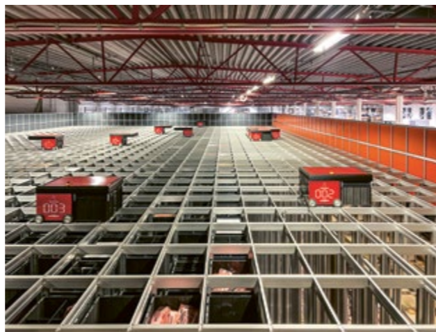
De tolv robotarna åker runt på skenorna och plockar i rask takt fram lådorna som de rätta reservdelarna ligger i. På natten sorterar de om lådorna så de ligger möjligast effektivt inför morgondagens arbete.
